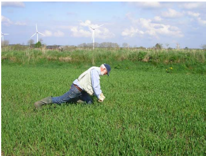
Figur 2. Det 1m lange karteringsspyd presses ned i jorden. Prøven sidder i en rille i spidsen. Jordarten bestemmes på stedet, og resultatet indtegnes på feltkortet.
