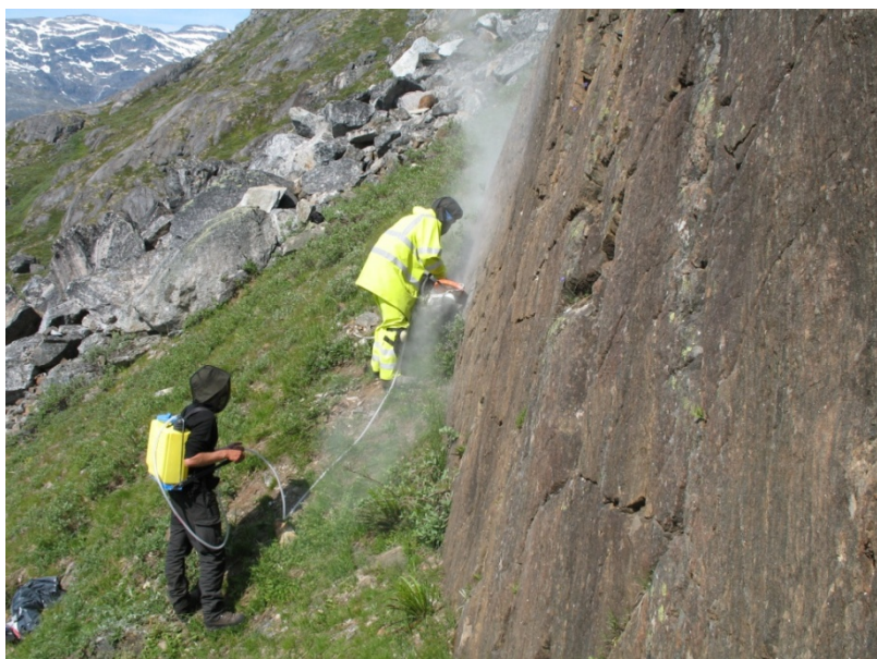
Figur 19. Prøvetagning – kanalprøver taget med stensav - af PGE-mineraliseret horisont ved Itie.
