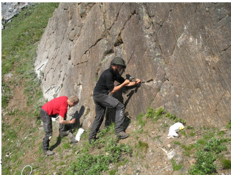
Figur 20. Prøvetagning udført med hammer og mejsel – kanalprøver - af PGE-mineraliseret horisont ved Itise.
