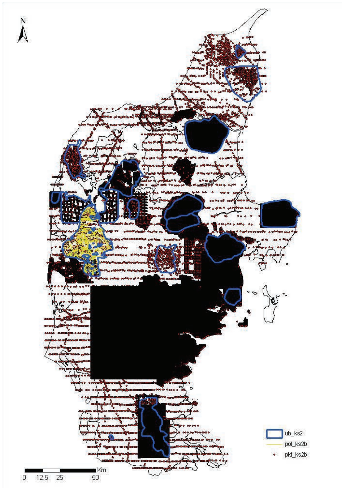
Figur 15. Tolkingspunkter og konverterede gridpunkter (pkt_ks2b), hjælpelinjer (pol_ks2b) anvendt til konstruktion af det hydrostratigrafiske lag KS2. Endvidere er udbredelsen af lokalmodeller der indgår i den geologiske opdatering (ub_ks2).
