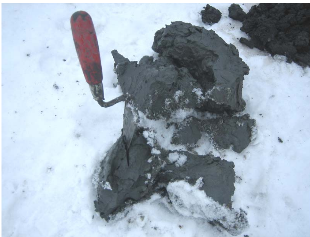
Figur 14. Nærbillede af Ølst Formationens plastiske ler, der indeholder tynde lag og udtværret lamination af vulkansk aske i boring 68.1138.
