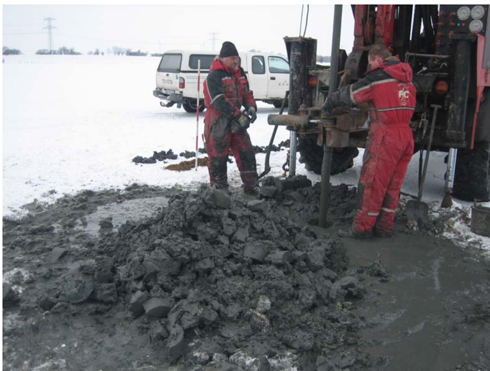
Figur 12. Snegleboring gennem Ølst Formationens øverste lag i boring 68.1138.
