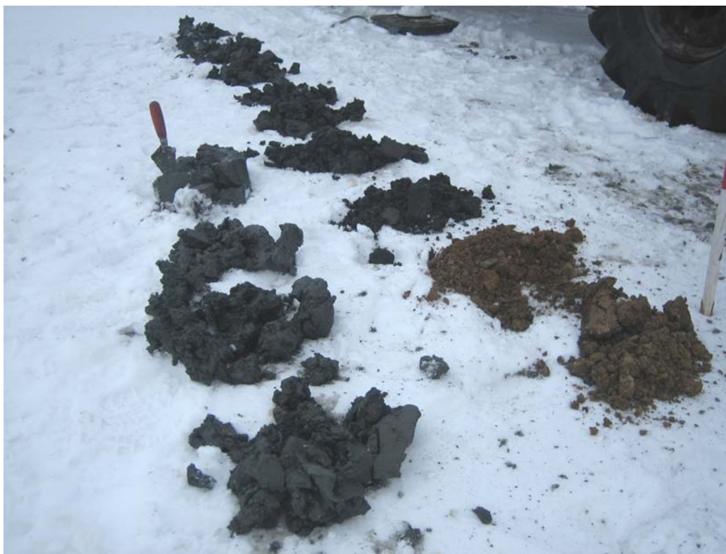
Figur 13. Prøveudtagning for hver 1 meter fra boring 68.1138. Bemærk de øverste 2 m til højre, som består af moræneler, resten af prøverne er plastisk ler.
