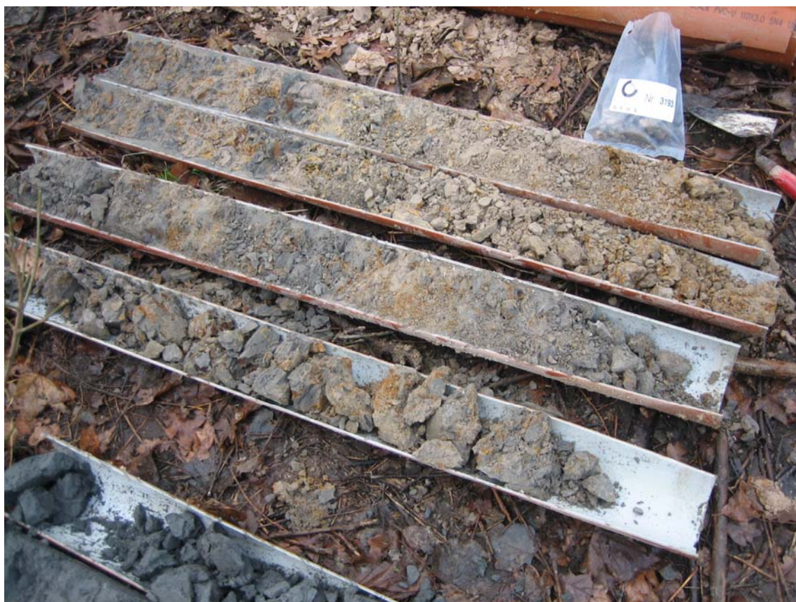
Figur 5. Skiftet fra lys beige farvet moler ved 17 meters dybde til mørk grå-sort moler i 20 meters dybde i boring DGU nr. 31.311 nord for det Gule Hus ved Skarrehage.
