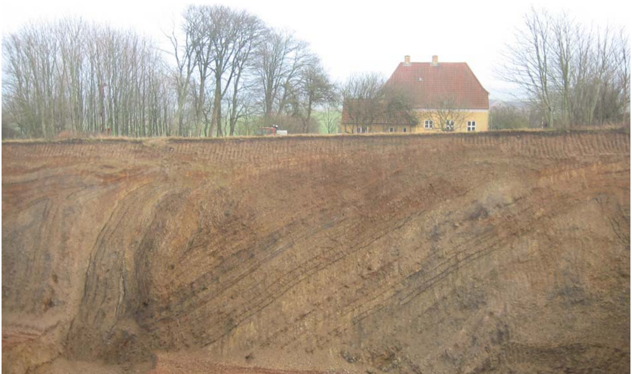
Figur 8. Profilet i Skarrehage molergravens skær neden for det Gule Hus. Bemærk boreriggens tårn mellem træerne, hvor boring DGU nr. 31.311 blev udført. Synklinalen som ses centralt i profilet (sammenlign med Fig. 9) fortsætter ind under det Gule Hus.
