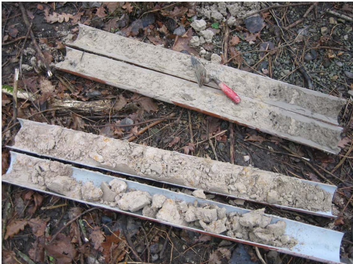
Figur 4. Kernerne af boring DGU nr. 31.311 fra 5–6 m og 6–7 m. Bemærk de sorte klaster til højre for murskeen der tolkes som itubrudte stykker af askelag ÷13.
