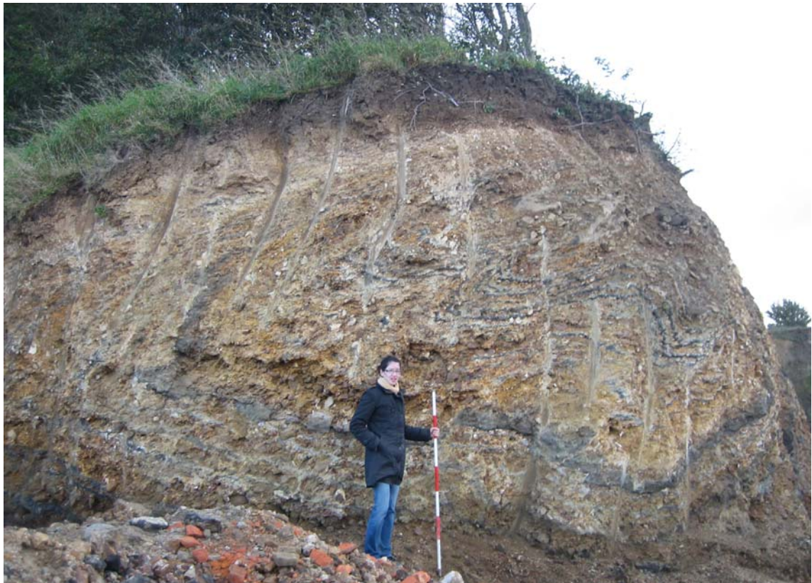
Figur 7. De øverste askelag som forekommer i Askelagsserien på hjørnet af Skarrehage molergrav nordvest for det Gule Hus. Askelagene er her stærkt foldet af shear deformation, hvorved folderne får lavt hældende til næsten horisontalt orienterede askialplaner.
