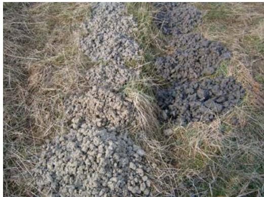
**Figur 10.** Alle stumper og stykker i bunken der repræsenterer en opboret meter undersøges for forekomsten af askelag, cementsten, lamination og eventuelle fossiler.
