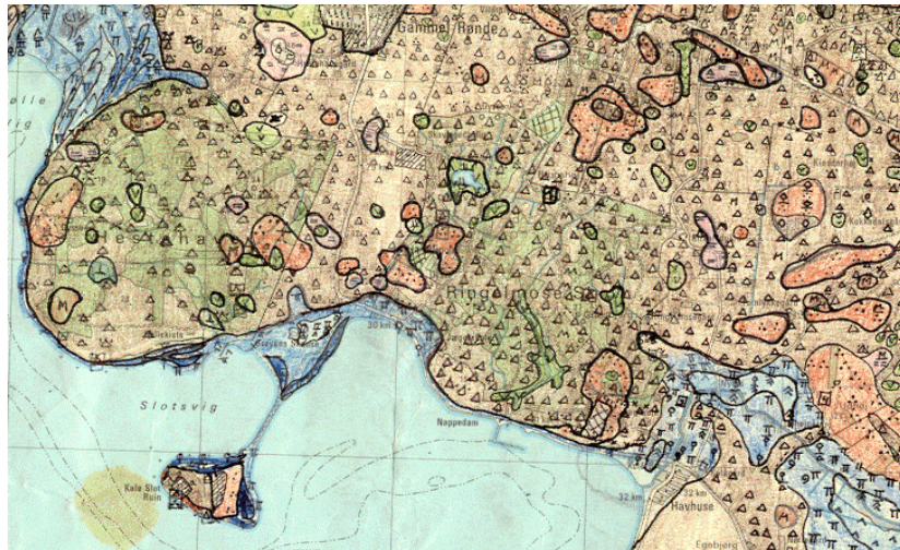
Figur 5. Et udsnit af rentegnet feltkort med karteringstegn og jordartsafgrænsninger fra 4cm kortet 1315 II SV Rønde..
