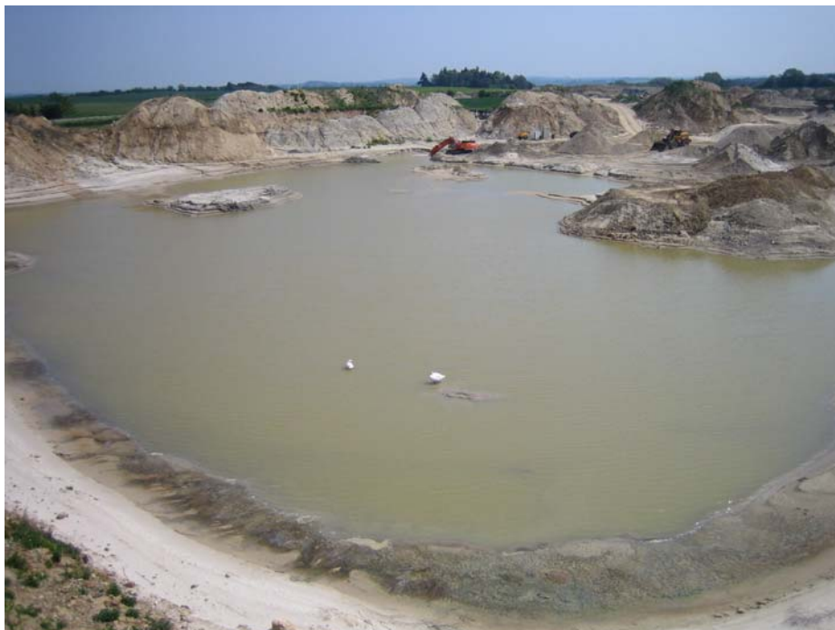
Fig. 3.7 St. Havelse grusgrav set mod sydøst. Grundvandsstanden er ca. 5 m u.t.. Der graves til ca. 4 - 5 m under vandoverfladen, og sedimentet er finkornet i hele sekvensen.
