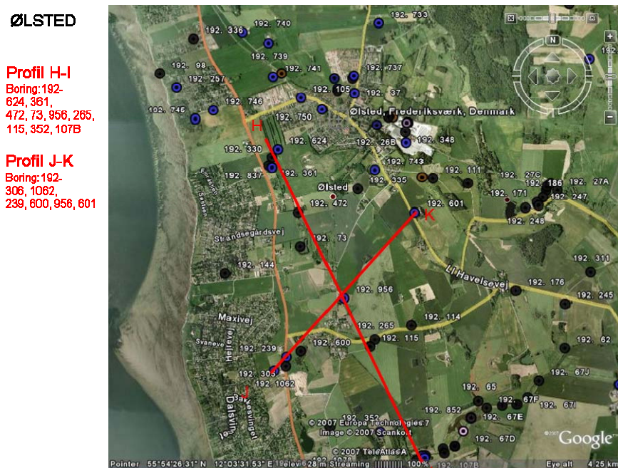
Fig. 3.4 Placering af boringer og tværprofiler i undersøgelsesområdet.
