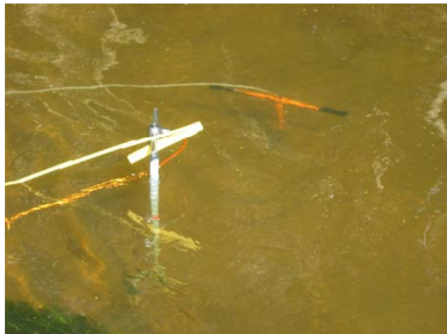
Figur 4. Temperaturspyddet ses til venstre og potentiometeret til højre. Spyddet presses ca. 0,5 m ned i bundsedimentet. De nederste 0,5 m af spyddet har 6 temperatursensorer placeret i forskellige niveauer.
