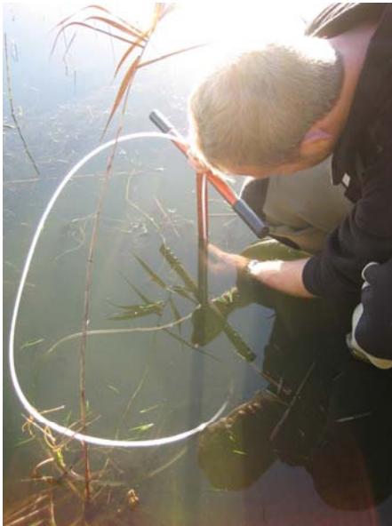
Figur 3. Trykniveaumåling med potentiometer.
