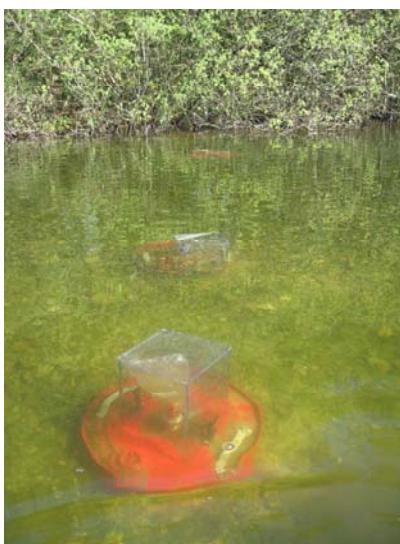
Figur 2. Seepagemeter. Foto stammer fra Hampen sø, da det uklare vand på mere end 0.5 m vanddybde umuliggjorde fotografering af seepagemetre i Skærsø.
