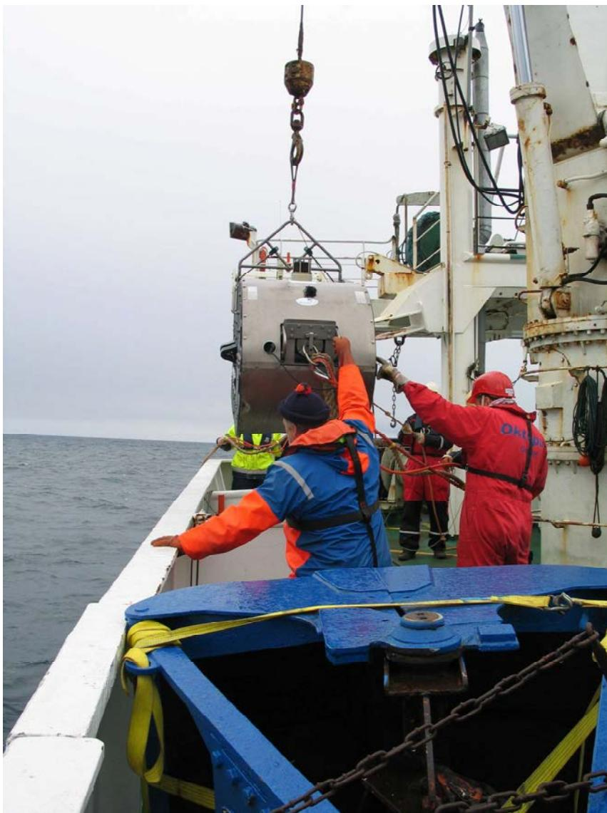
Fig. 4. Side-scan sonar DT-1 hvor den er ved at blive sat i vandet over skibets styrbords ræling.
