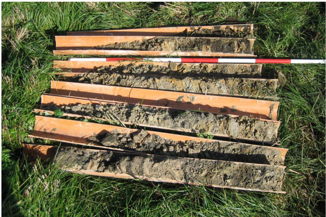
Figur 6. Opborede kernestykker med askelag i moler fra 3 til 7 m i boringen MolerMus I. Den nederste kerne er oven for landmålerstokken, hvis inddelinger er 20 cm. Bemærk at kernerne generelt er sammenpresset mod bunden, hvorimod de er løst kompakteret i toppen af kernen.
