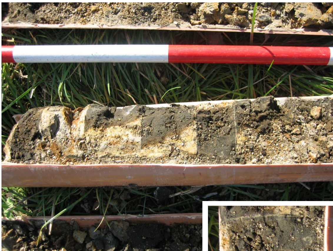
Figur 8. Detalje af stejlstående askelag i bunden af boring MolerMus I. Intervallerne på landmålerstokken øverst er 20 cm. Bemærk af vridningsplanerne er vinkelret på borekernens PVC-væg. Som det ses ved knivsæggen på lommekniven hælder askelaget ca. 60°-70°. Som det fremgår af loggen på Fig. 7 har boringen boret sig igennem det stejlstående tykke askelag i næsten hele det en meter tykke interval mellem 6 og 7 m under terræn.
