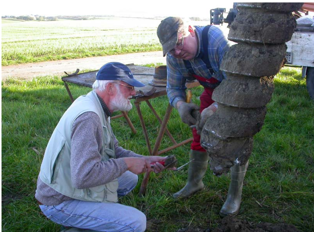
Figur 4. Boremateriale ophentet ved hjælp af snegl skræbes af og undersøges.
