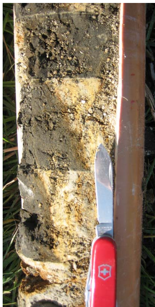
Figur 8. Detalje af stejlstående askelag i bunden af boring MolerMus I. Intervallerne på landmålerstokken øverst er 20 cm. Bemærk af vridningsplanerne er vinkelret på borekernens PVC-væg. Som det ses ved knivsæggen på lommekniven hælder askelaget ca. 60°-70°. Som det fremgår af loggen på Fig. 7 har boringen boret sig igennem det stejlstående tykke askelag i næsten hele det en meter tykke interval mellem 6 og 7 m under terræn.
