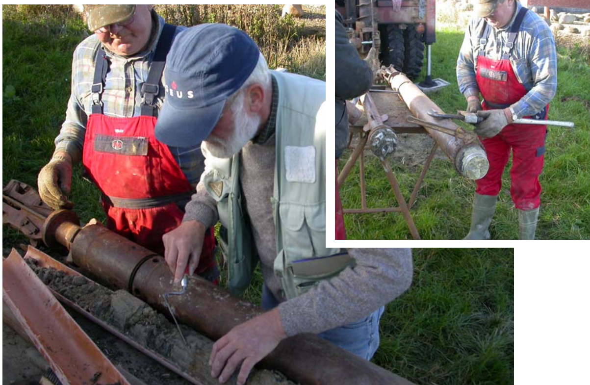
Figur 5. Kernehenter med frilagt kerne. Til højre ses kernen i borespids, og herover er PVC-røret blevet splittet, så det opborede materiale er blevet blotlagt.
