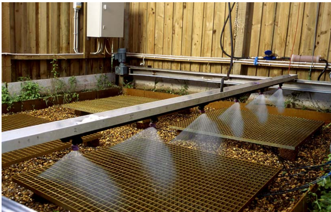
Figur 24: Sprinklersystem over forsøgsblokken, hvor glyphosat og andre sporstoffer tilsættes.
