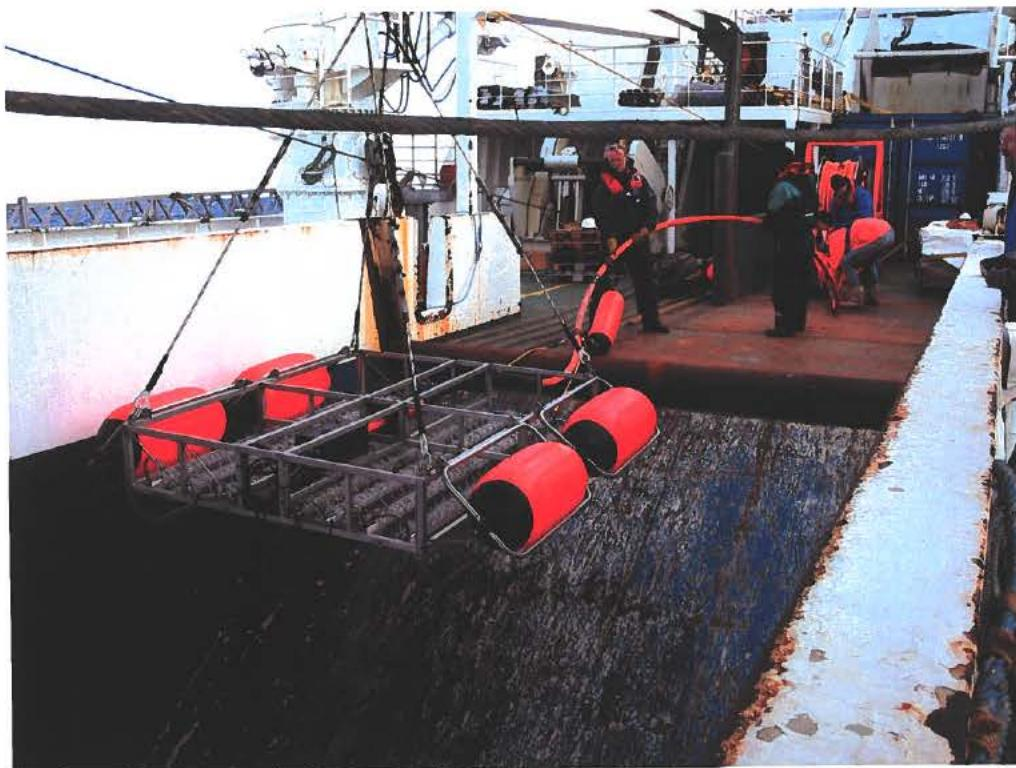
**Fig. 8.** GEUS dybvandssparker (GEO-Spark 800) under udsætning gennem trawl-gangen på H/F DANA. Sparkeren slæbes gennem vandet efter skibet i det orange strømførende kabel, der via kabelspillet er forbundet til strømforsyningen placeret i den blå container.
