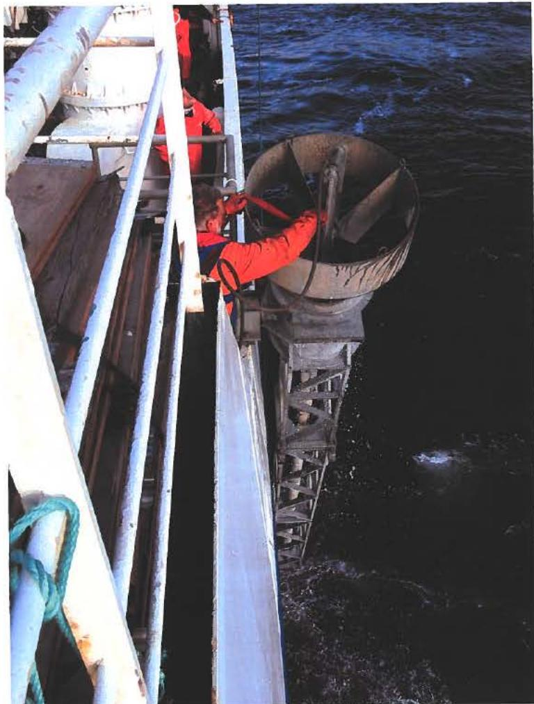
**Fig. 6.** GEUS piston corer placeret i transportvuggen på bagbords side af H/F DANA.
