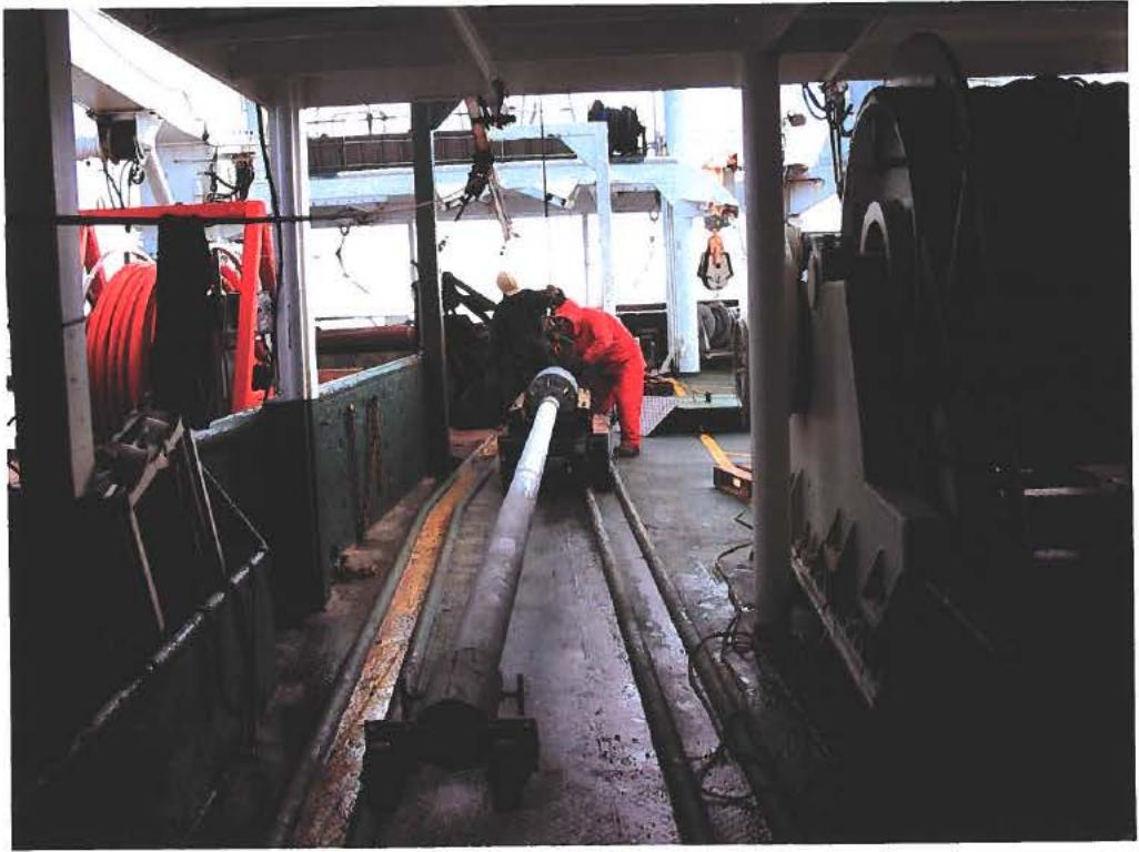
**Fig. 5.** GEUS 6 m gravity corer på agterdækket af H/F DANA.
