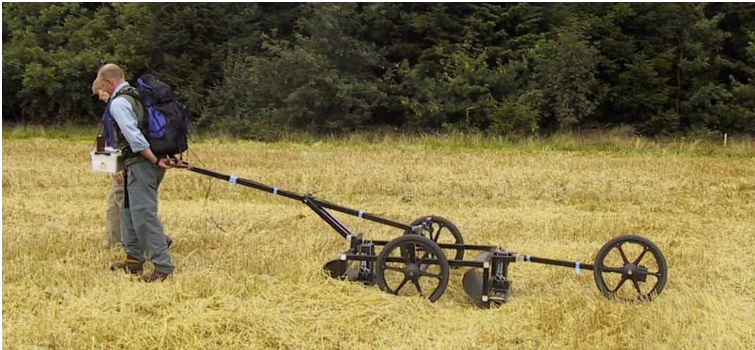
Figur 5. Sensors & Software pulseEKKO 100A georadarsystem med antenner monteret på vogn. Det bagerste hjul (odometer) måler afstand, og udløser målinger for den valgte måleafstand.
