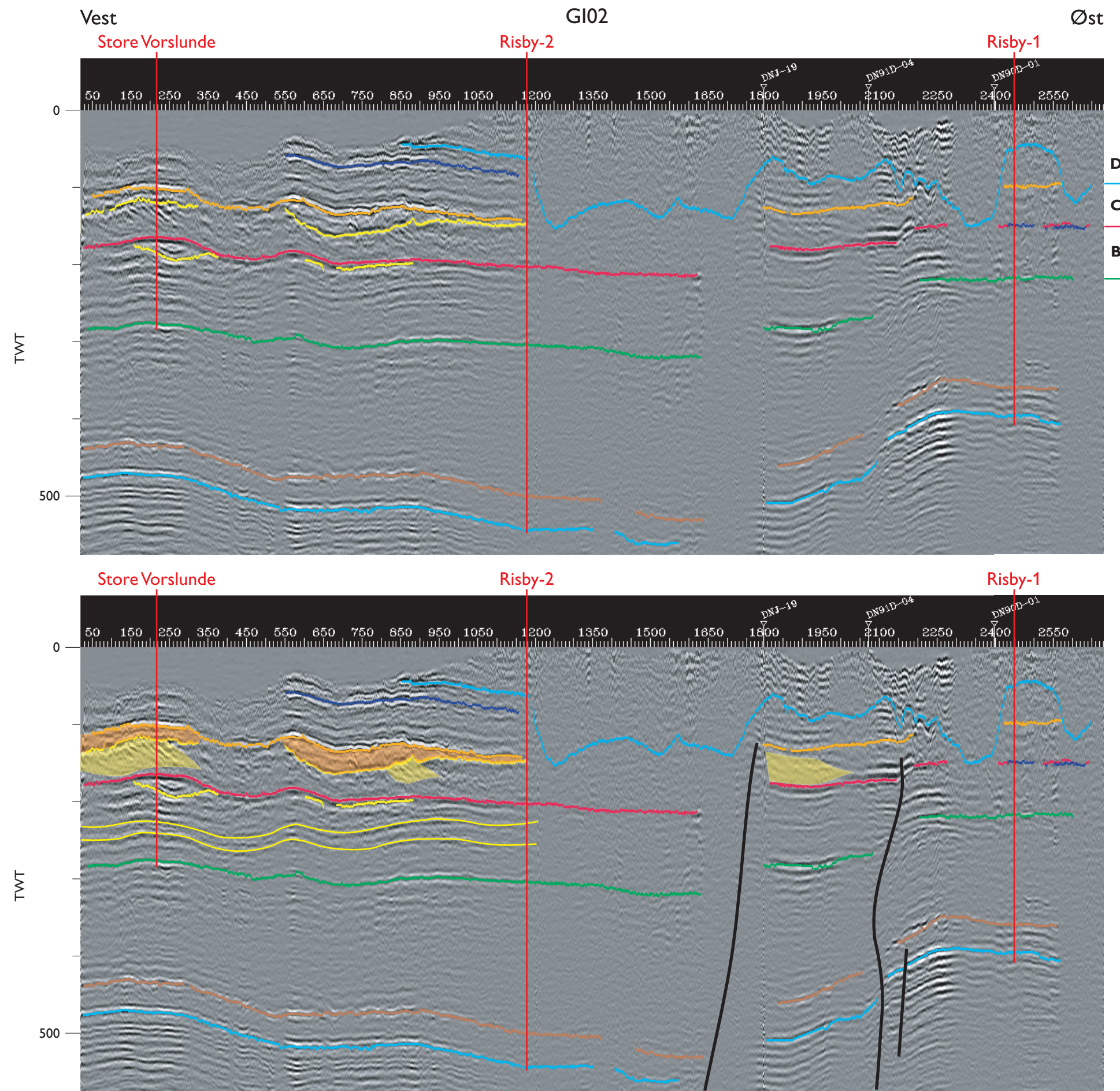
Fig. 13: Øst – vest gående seismisk linie GI02. Bemærk at det kliniforme refleksionsmønster er angivet med gult på den tolkede sektion og nedskårne dale med orange. (seismisk data COWI).
