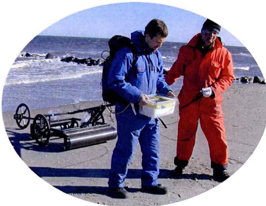
Figur 2. Georadar-måleudstyret betjent af 2 personer kan typisk udmåle 7 km linier per dag
