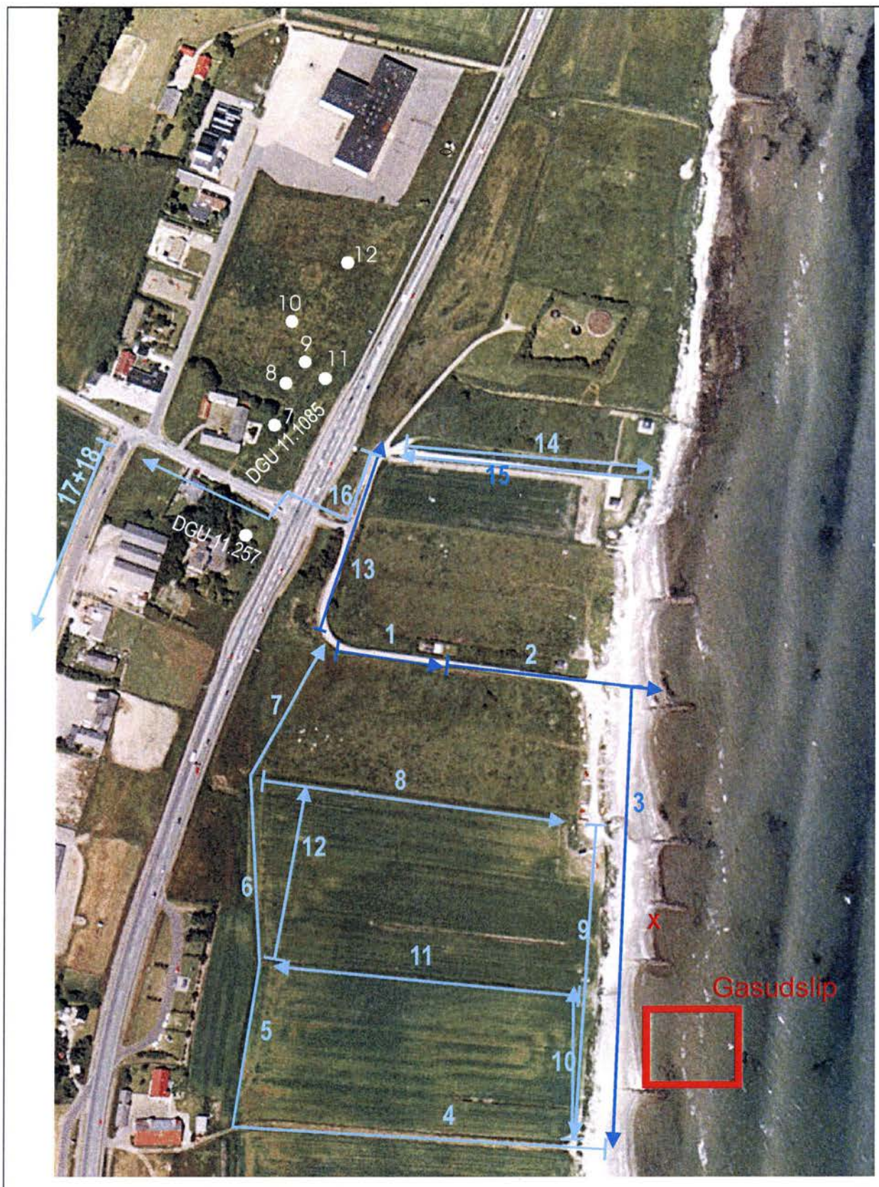
Figur 9. Georadarlinier indtegnet på luftfoto over det undersøgte område. Rødt kryds nord for gasudslip markerer fund af "koraller" den 6. april. Fotoet er taget før bygning af transportcenter og motorvej.
