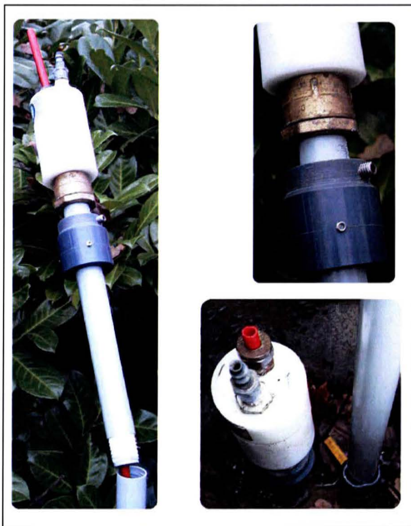
Figur 6. Montejus boring DGU nr. 201.3795-2 bestående af 40 mm et gråt PVC-rør, hvori der er anbragt et hvidt 32 mm PVC rør. Unbraco skruernes dimension er 6 mm henholdsvis 3 mm. Teflon topstykket er monteret på 32 mm røret ved hjælp af et stk. 32 mm Isiflo nipple.
