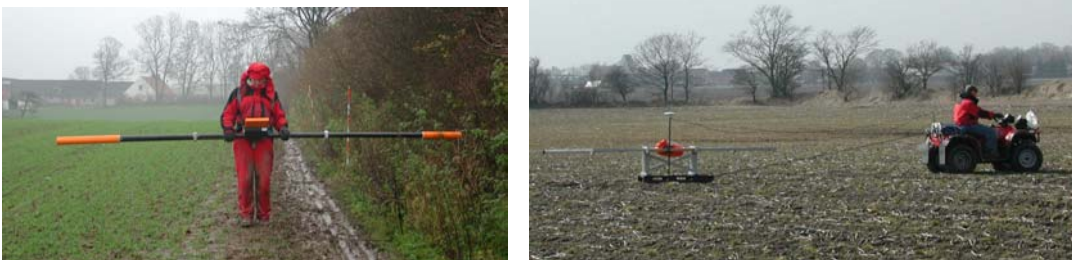
Figur 4.9. Foto (til venstre) af Geofysika CM-031 (~ Geonics EM31) systemet anvendt i felten (Foto Thomas Røntved). Foto (til højre) af Geonics EM31 systemet monteret på en slæde og trukket af en terrængående motorcykel (Foto DJF).
