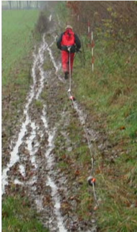
Figur 4.3. Foto (til venstre) af Geometrics OhmMapper anvendt i felten. (Foto Thomas Røntved). Skitse (til højre) af OhmMapper-systemet. Sender og antennerne, som udgør den kapacitivt koblede sender-dipol er placeret bagest og styres fra modtageren med radiolink. Modtager og den kapacitivt koblede modtager-dipol er placeret tættest på personen, som trækker udstyret og bærer styringspanel og skærm.
