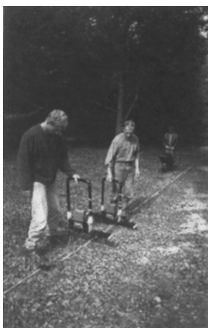
Figur 4.11. Foto (til venstre) af georadar system. Principskitse for profilering med georadar. På skitsen af den geologiske model øverst til højre er radarstrålerne vej vist for 3 positioner. Skitsen nederst til højre viser det resulterende radargram, hvor den vertikale akse er tovejstid (van Overmeeren et al (1997)).
