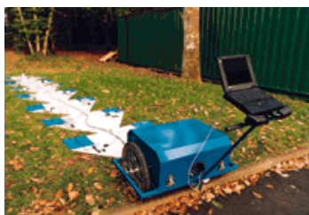
Figur 4.4. Foto (til venstre) af Iris Instruments CORIM system. Skitse (til højre) af CO-RIM system. Systemet benytter ækvatorial dipol-dipol elektrodekonfigurationer med 6 dipolafstande. (Fra Iris Instruments' hjemmeside).
