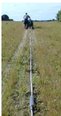
Figur 4.1. Foto (til venstre) af det slæbegeoelektrisk system anvendt i feltet. I forgrunden ses en af elektroderne og det kabel, elektroderne er påmonteret. Øverst på fotoet ses det lille bæltekøretøj, som trækker elektrokablet og transporterer instrumentel. (Fra GeofysikSamarbejdet (2000)). Skitse (til højre) af slæbegeoelektriske elektrodekonfigurationer. Linierne s1, ..., s8 viser elektrodekonfigurationerne hver for sig. Linierne s1, .. s4, s6 er pol-pol-agtige opstillinger, s5 og s8 er Wenner opstillinger og s7 er en symmetrisk opstilling. (Fra Møller et al. (2001)).
