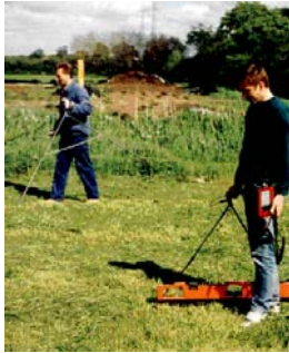
Figur 4.8. Foto (til venstre) af Geonics EM38 systemet anvendt håndbåret i feltet. Skitse (til højre) af EM38-systemet rigget op med GPS og trukket af en terrængående motorcykel.
