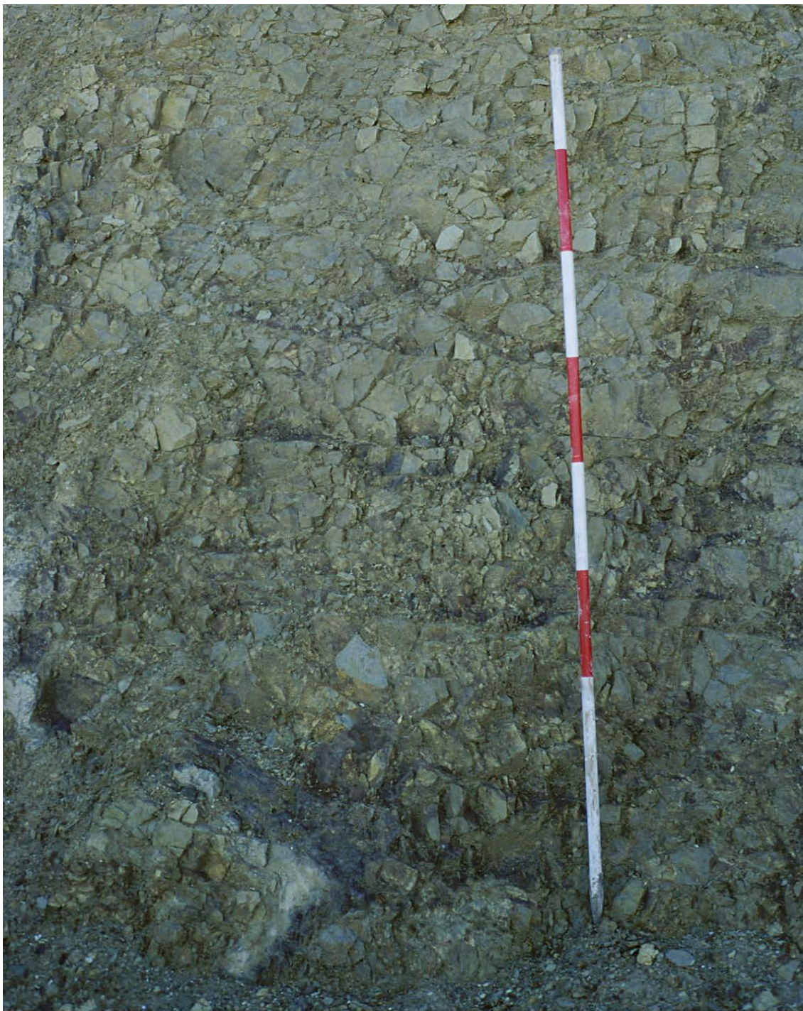
Figur 22. Eksempel på brecciering (dannelse af brokket moler). Bemærk specielt de horisontale sprækker, som er dannet under F_2 deformationens reorientering af lagene.
