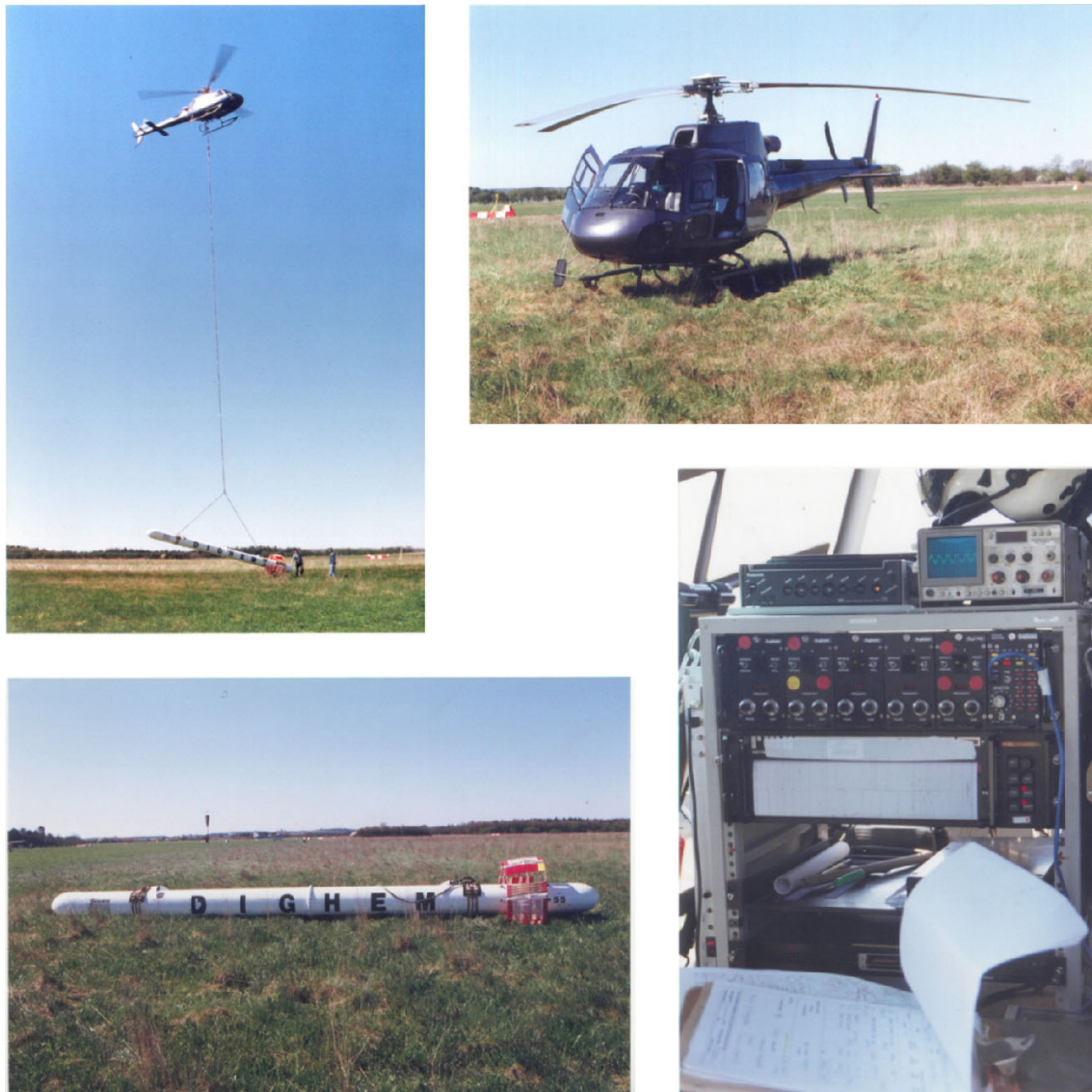
Figur 1.1. Figuren viser det helikopterbårne DIGHEM VRES system. På billederne ses helikopteren og instrumenteringen, beholderen med spolerne og systemet klar til at lette.
