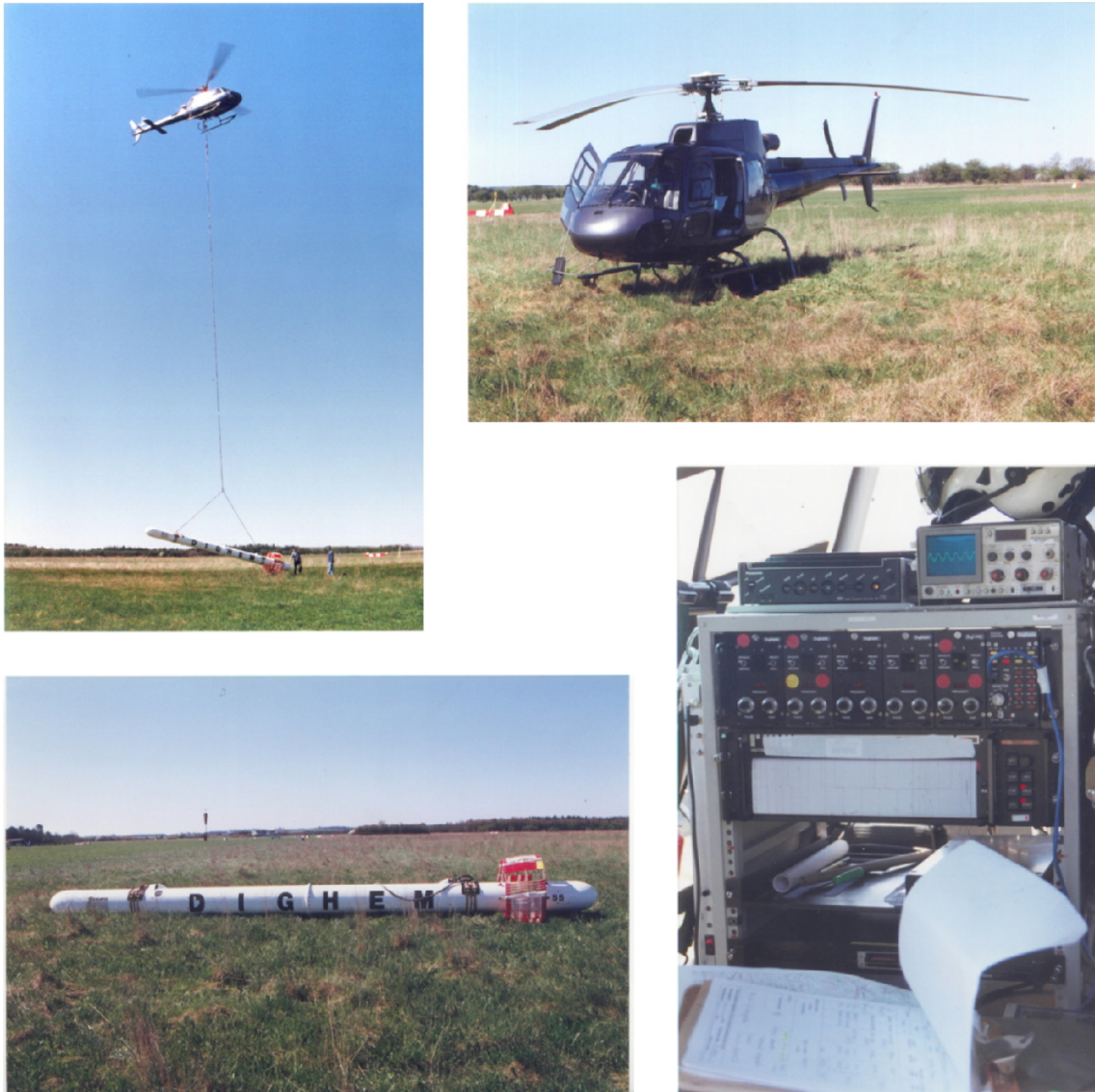
Figur 1.1. Figuren viser det helikopterbårne DIGHEM system. På billederne ses helikopteren og instrumenteringen, beholderen med spolerne og systemet klar til at lette.
