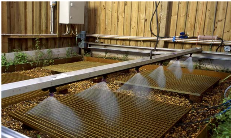
Figur 19: Sprinklersystem over forsøgsblokken, hvor tracere og pesticid tilsættes (fra Mortensen, 2001).
