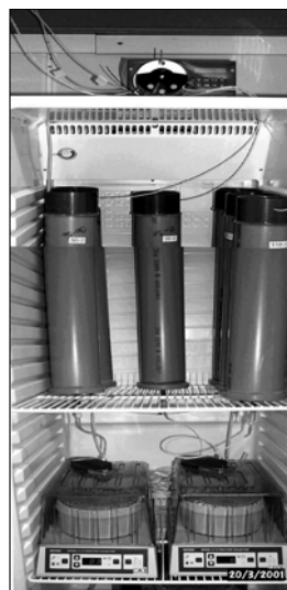
Figur 7: Inkubation af intakte jordsøjler ved 10° C til studie af transport af pesticider.
