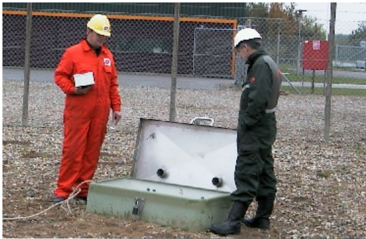
Figur 2. Boring DGU nr. 47.767 beliggende centralt på gaslager området. Råvandshane er forsynet med 1/2" gevind. En eller flere haner i administrationsbygningen åbnes for at sikre, at pumpen arbejder mens der udtages prøver.
