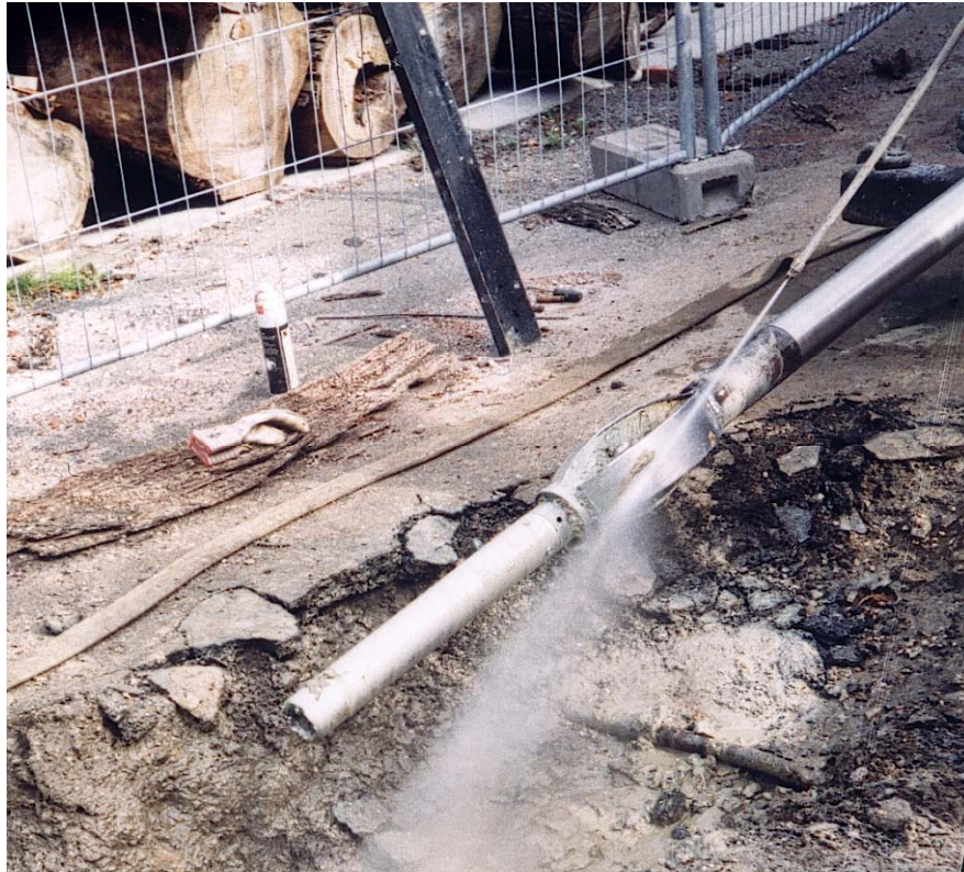
Figur 17. Prøvetageren til indsamling af "uforstyrrede" prøver i en vandret boring er her monteret i enden af borerøret. Vandstrålen rammer en af de slæder ved prøvetagerens rod, som er beregnede til at holde prøverøret fri af borehullets vægge.
