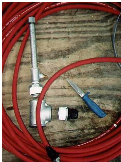
Figur 28. Tryktransducer med kabel og topafslutning til monitoringsrør i ikke samlet tilstand.
