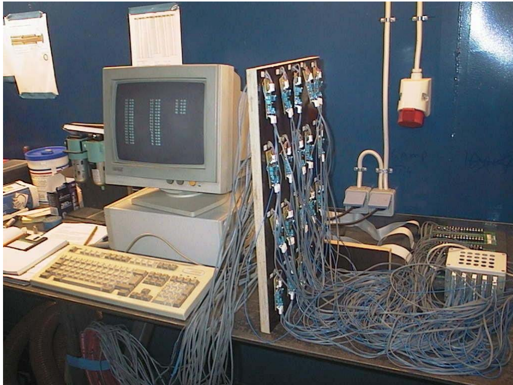
Figur 34. Systemet til opsamling af signal er her forbundet til tryktransducerne (under bordet), A/D converteren (på bordet) og computeren hvor data lagres.
