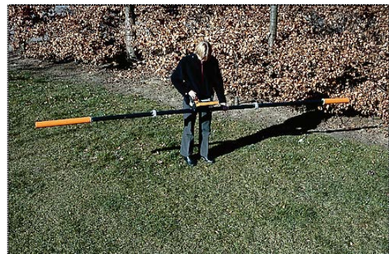
Figur 7. CM-031 instrumentet. Fotoet til venstre viser CM-031. Instrumentet er 4,5 m langt. I midten sidder en minicomputer til aflæsning og opsamling af data. Fotoet til højre viser den typiske måleopstilling, hvor instrumentet bliver båret i et bælte omkring hoften. Foto: Henrik Vosgerau, GEUS.
