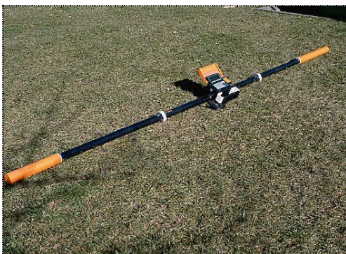
Figur 7. CM-031 instrumentet. Fotoet til venstre viser CM-031. Instrumentet er 4,5 m langt. I midten sidder en minicomputer til aflæsning og opsamling af data. Fotoet til højre viser den typiske måleopstilling, hvor instrumentet bliver båret i et bælte omkring hoften. Foto: Henrik Vosgerau, GEUS.
