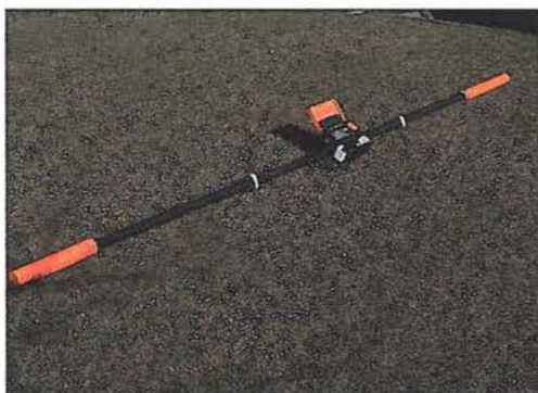
Figur 3. CM-031 instrumentet. Fotoet til venstre viser CM-031. Instrumentet er 4,5 m langt. I midten sidder en mini-computer til aflæsning og opsamling af data. Fotoet til højre viser den typiske måleopstilling, hvor instrumentet bliver båret i et bælte omkring hoften. Foto: Henrik Vosgerau, GEUS.
