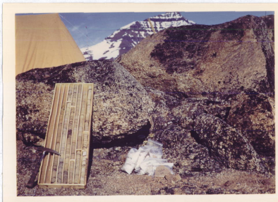
Foto nr. 6. Bohrkerne in Kernkiste.
